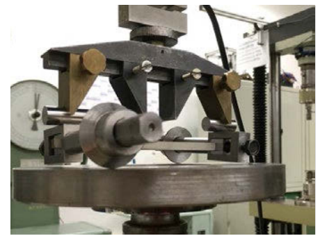
Abb. 6 Versuchsaufbau für Biege-Torsionsversuche
