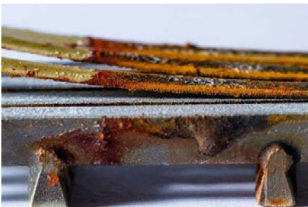
Abb. 5 Beispiel für das Ablösen einer Funktionsschicht vom Profildraht ohne Einsatz einer Haftschiicht
