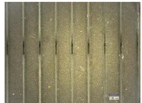
beschichteter Filter nach Erosion
