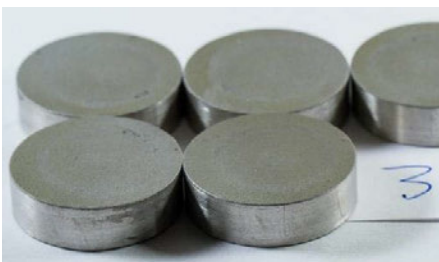
Abb. 4 Beschichtete Ronden vor Korrosion
